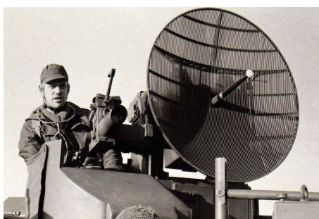
Radar-antennen på skyderadar
